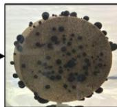
Test de inhibición espontánea mostrando recuperación de petróleo con NanoCLEAR®
